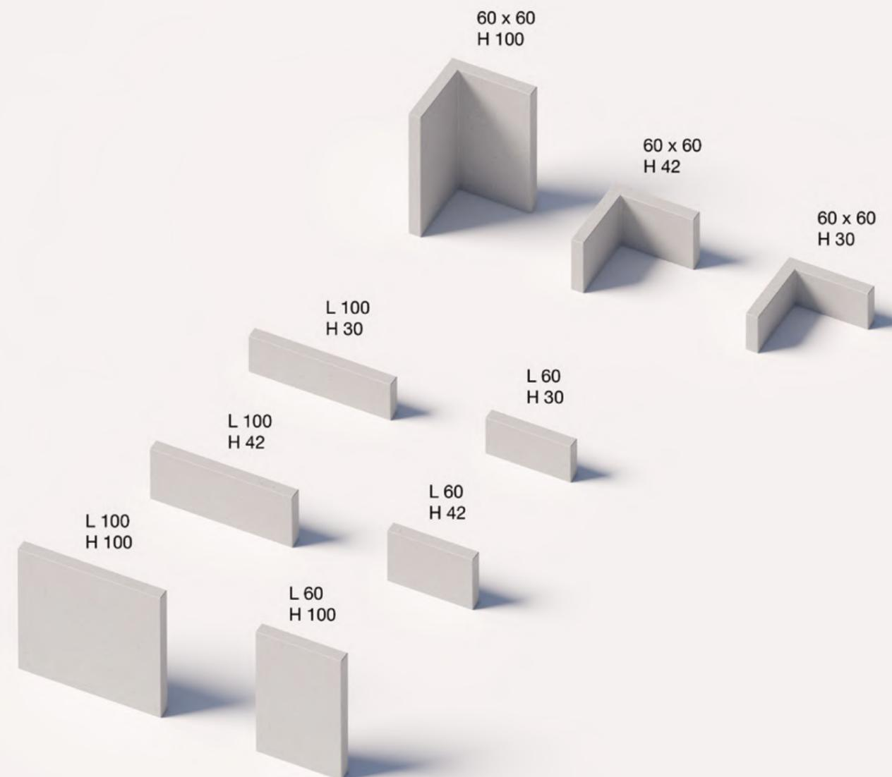
Anello è composto da tre moduli angolari e sei lineari, tutti di uno spessore costante. Tramite un sistema di connessioni meccaniche e piastre in acciaio, l'intera configurazione garantisce durabilità e sicurezza dell'arredo urbano composto.
