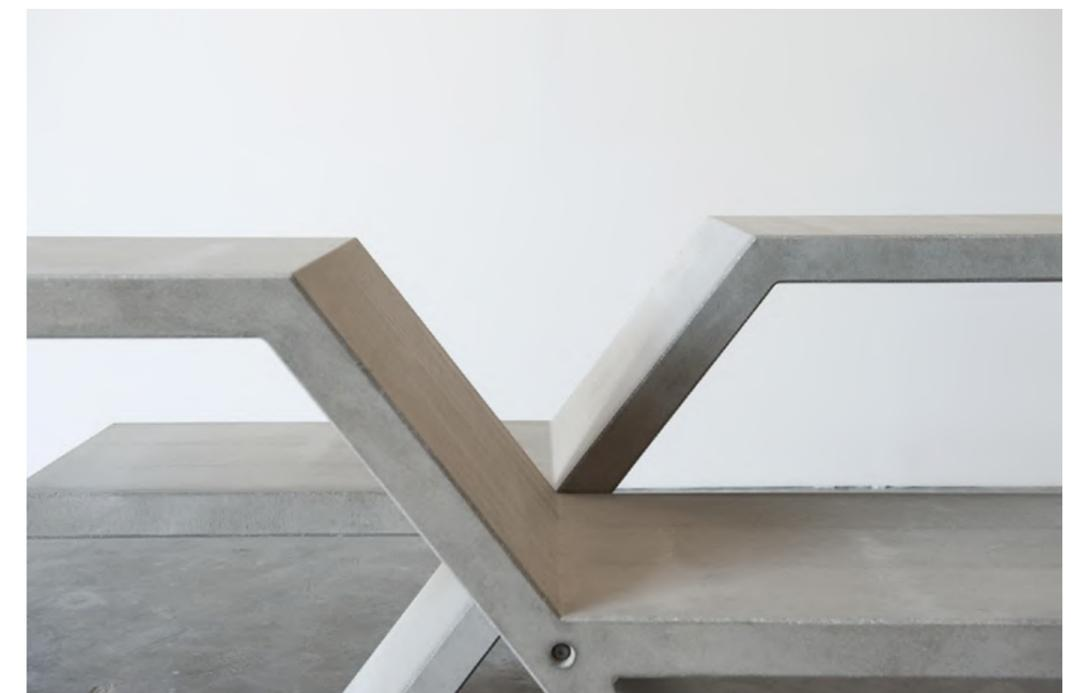
Sistema composto da due moduli sagomati per essere allo stesso tempo seduta e tavolo, collegati e bloccati tra loro tramite fissaggio meccanico e ancorati alla base in acciaio zincato. Sono realizzati in conglomerato cementizio armato ad alta resistenza. Finitura liscia e trattamento protettivo antigraffiti a base di cere naturali.
